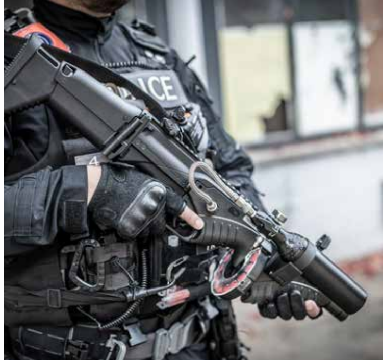
Le moyen de force intermédiaire FN 303® est un lanceur à air comprimé
