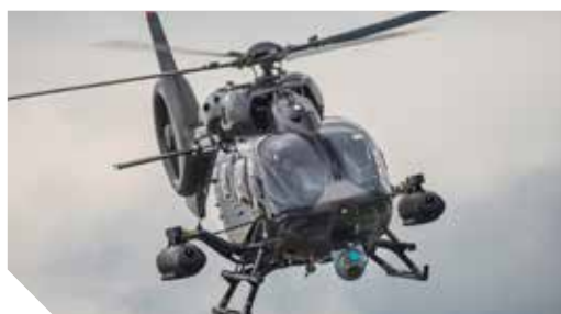
Les systèmes FN® Pod de chaque côté de l'hélicoptère sont équipés d'une mitrailleuse FN® M3M
