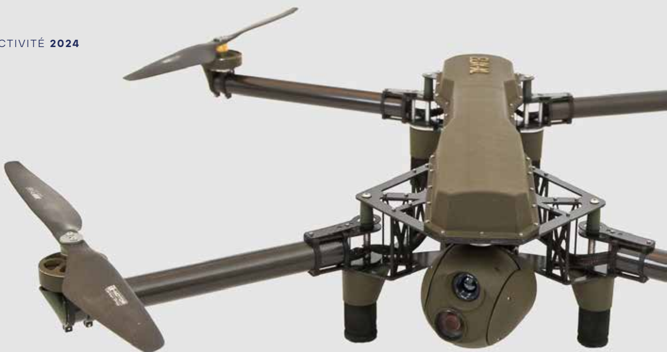
UAV avec télémètre laser Noptel
