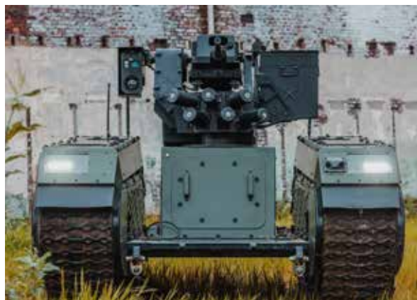
Dans le cadre d'un projet EDF, une station d'armement à distance FN DEFENDER a été montée sur un véhicule terrestre sans pilote (UGV) Milrem THeMIS.
